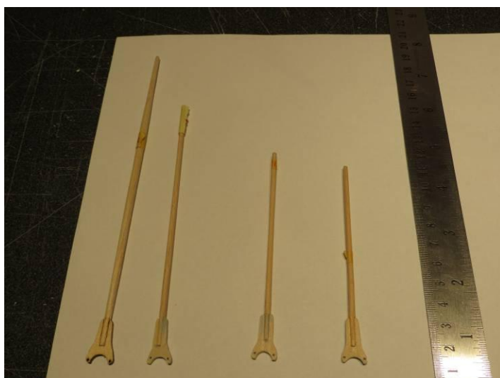
Fregatten Jylland er udstyret med (fra højre imod venstre) foregaffel, store gaffel, mesangaffel og mesanbom. Igen er hvert rundholt slebet tyndt imod spidsen. Selve gaflen er fremstillet i et stykke med et spor til rundholten og tilpasset de maste sektioner de skal bruges til.
